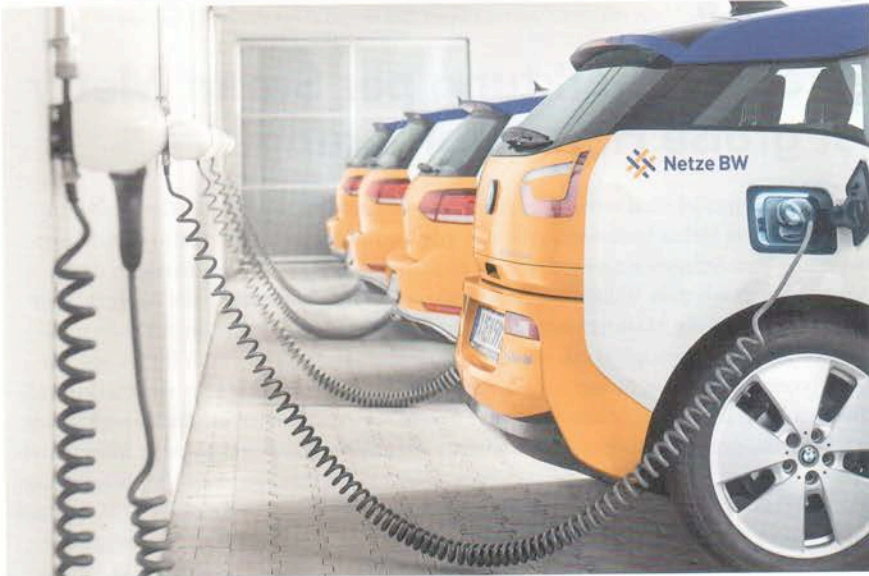
Im Feldtest E-Mobility-Carré mit 58 Ladepunkten zeigte sich, dass nie mehr als 13 Ladevorgänge parallel stattfanden. Bild: Netze BW
